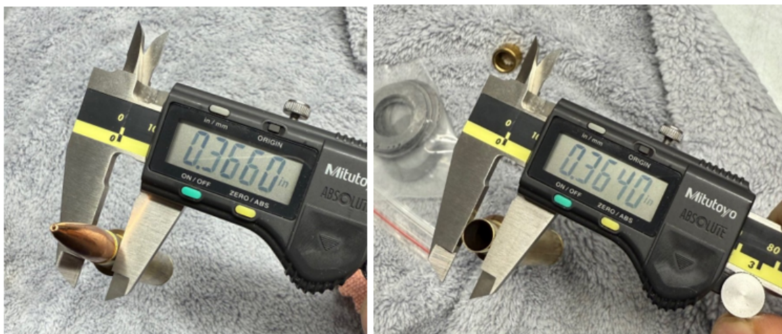
Рисунок 4. Диаметр дульца с пулей; диаметр дульца до посадки пули
