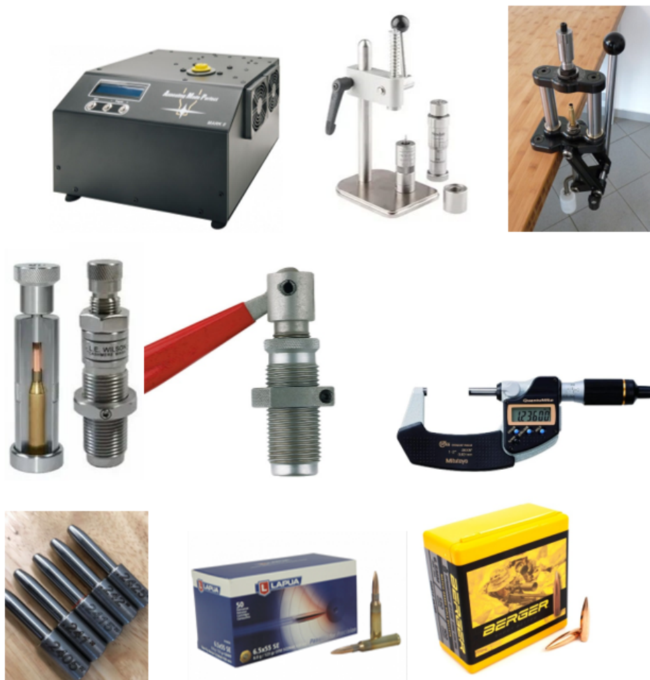
Рисунок 1. Индукционная печь AMP для отжига латунной гильзы, резьбовой пресс Turban 105, резьбовая и нажимная матрицы Wilson для обжима гильзы и посадки пули, нажимной пресс Sienclar, микрометр Mitutoyo, депулер Hornady, набор мандрелов 21 st Century, гильзы Lapua в калибре 6.5x47 Lapua и 6.5x55 SE, пули Berger VLD 130 gr
