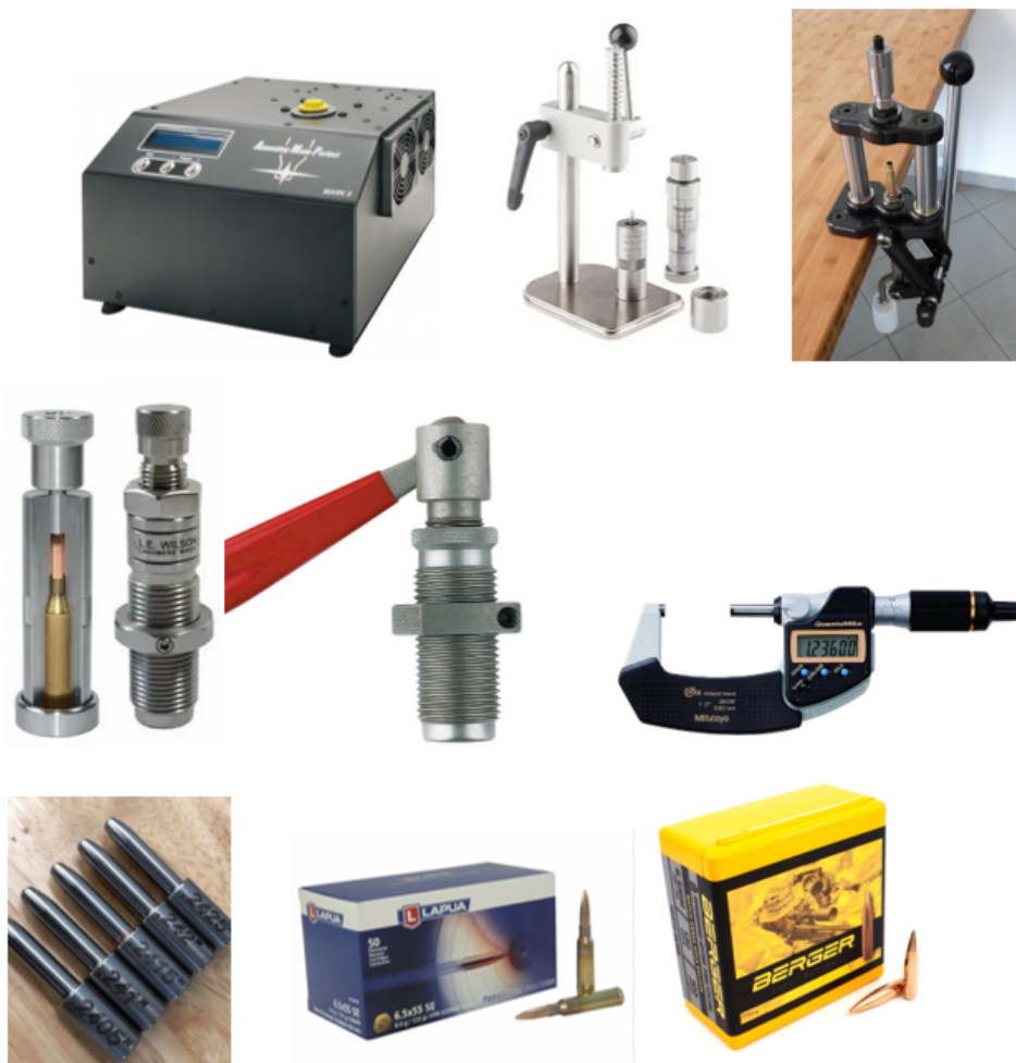
Рисунок 1. Индукционная печь AMP для отжига латунной гильзы, резьбовой пресс Turban 105, резьбовая и нажимная матрицы Wilson для обжима гильзы и посадки пули, нажимной пресс Sienclar, микрометр Mitutoyo, дедулер Hornady, набор мандрелов 21 st Century, гильзы Lapua в калибре 6.5x47 Lapua и 6.5x55 SE, пули Berger VLD 130 gr
