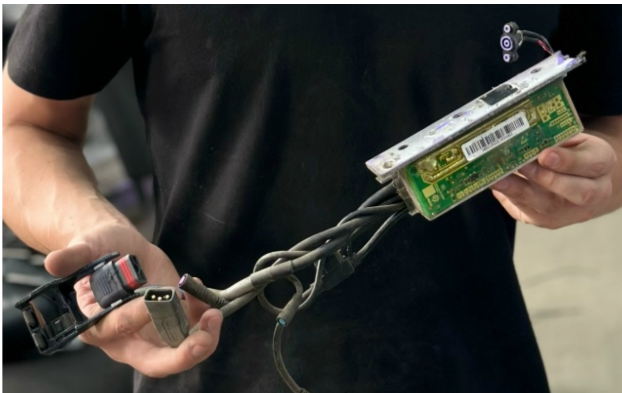
Рисунок 2. Электронный контроллер самоката: вид со стороны печатной платы (фото автора)
