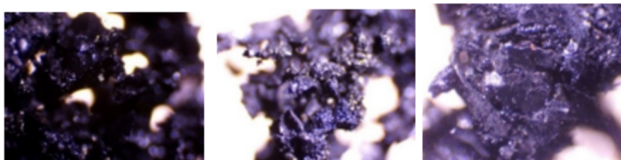
Рисунок 9. Микроскопическое изображение резинового порошка с добавлением 200 г Sika Latex
