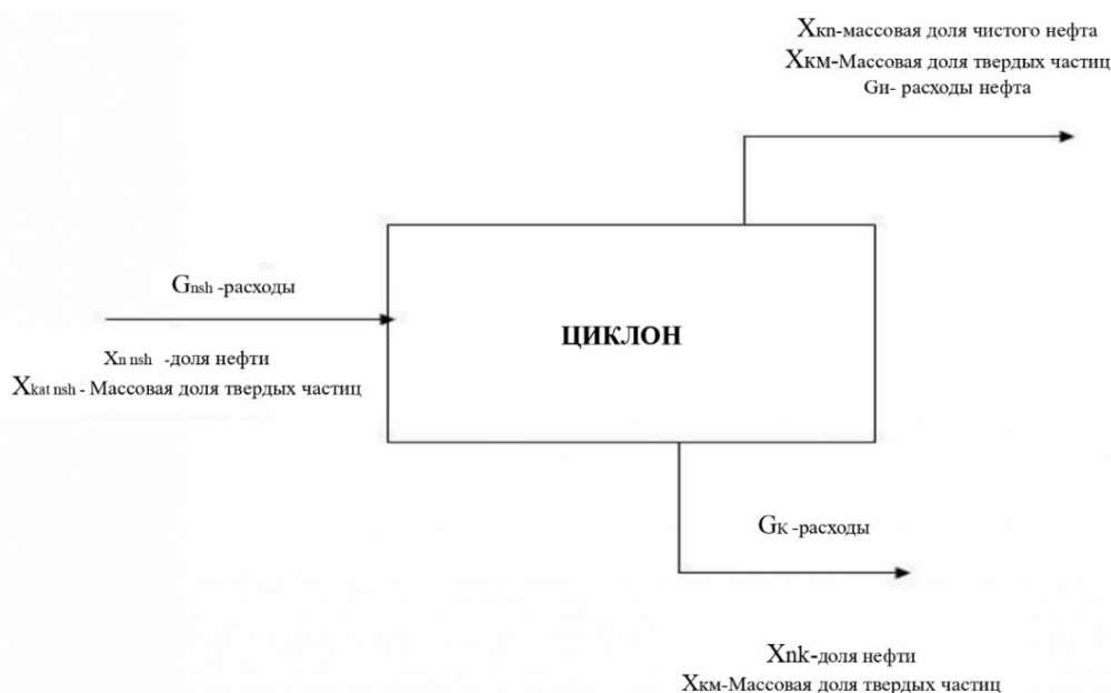
Рисунок 1. Структурная схема технологического процесса
