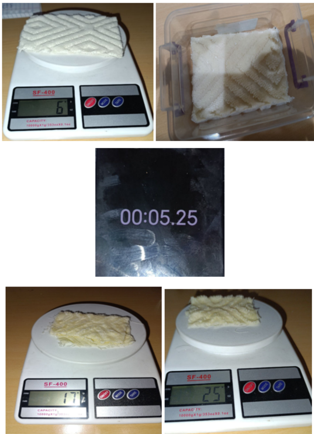
Рисунок 2. Этапы определения водопоглощающей способности разработанной ткани: а – сухой образец; б – процесс насыщения водой; в – время испытания (5 с); г – масса велюровой поверхности после испытания; д – масса петельной поверхности после испытания
