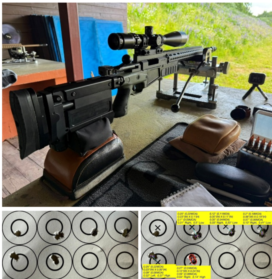
Рисунок 3. а-винтовка Ассигасу АХ на стрелковом столе; б, в, – 5 контрольных групп по 3 выстрела после настройки винтовки
