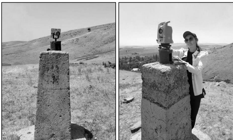
Рисунок 3. Отражатель и тахеометр на геодезическом пункте
