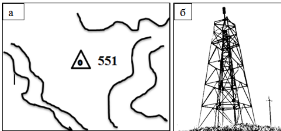
Рисунок 2. Изображение пункта ГГС : а- на топографической карте, б - на местности
