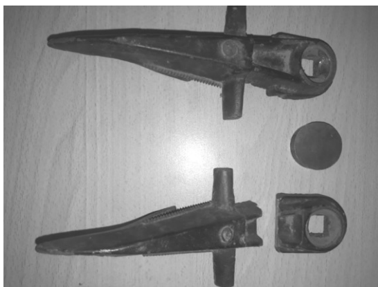
Рисунок 1. Пальцы сенокосилки (сломанные и не сломанные). В середине показан образец, изготовленный литем стали 35 L, который используется при исследовании процессов термохимической обработки
