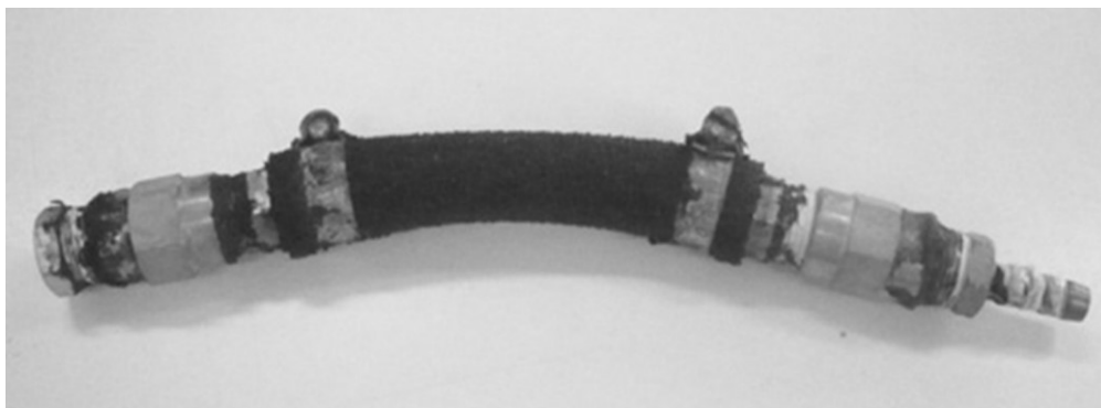
Рисунок 1. Гибкая аэрационная трубка из резины
