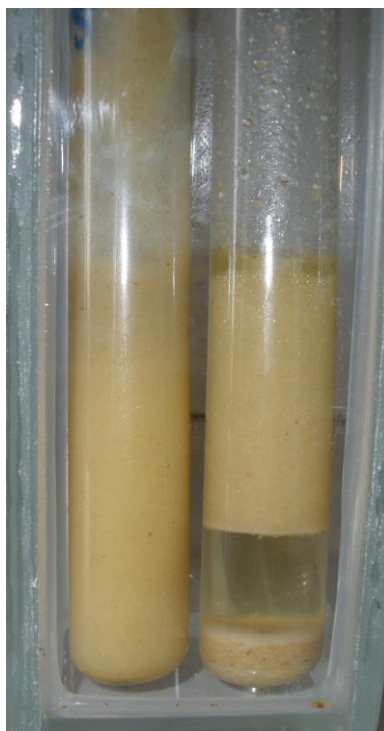
Рисунок 2. Эмульсия, устойчивая против коалесценции (справа), и эмульсия, устойчивая как против коалесценции, так и против седиментации (слева). Стабилизатор — горчичный порошок 30 и 5 % (масс).
