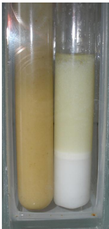
Рисунок 1. Эмульсии, стабилизированные горчичным порошком (слева) и сухим молоком (справа). Концентрация порошка в водной фазе 30 % (масс) в обоих случаях
