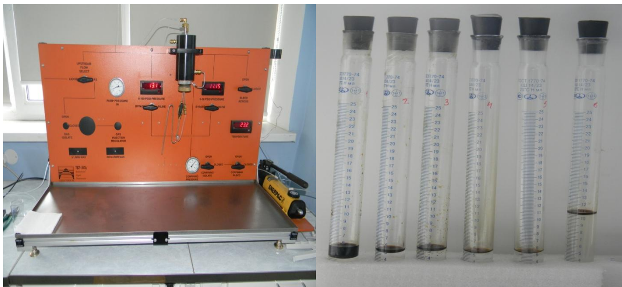
Рисунок 3. Установка многофазной фильтрации через керн ТВР-604 Coretest Systems и отобранные 7 поровых объемов жидкости после вытеснения нефти раствором ТНХС-14.0
